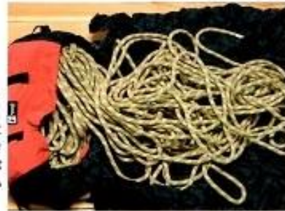
上から8.2mm、9mmのダブルロープ、10.2mm、11mmのシングルロープ。アルパインではダブルロープがもっともよく使われる
